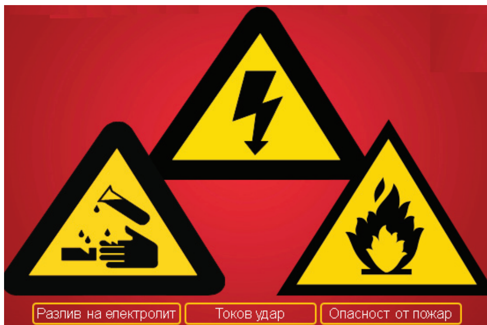
Фиг. 9 Рискове при ПТП с автомобили захранвани с допълнителен електрически елемент с висок волтаж.
