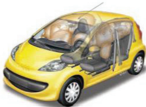
Фиг. 21 В някои случаи безопасната работна зона в автомобила е доста ограничена.
