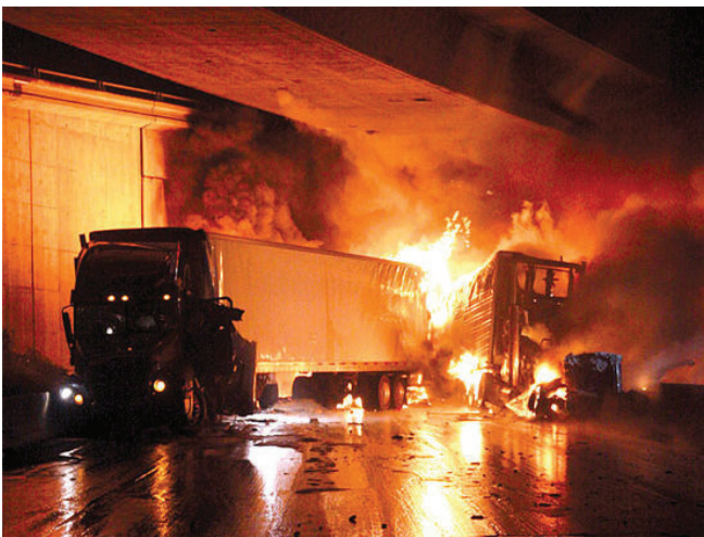
Фиг. 2 Пожарите в тунели се усложняват от ограниченото пространство, развитието на пожар с висока температура и спецификата на горене на превозваните материали ако те са огнеопасни. От голямо значение е и вентилацията, естествена и принудителна. Командването на процесите спомага за създаване на възможност за спасяване на пострадалите вследствие на инцидента.
