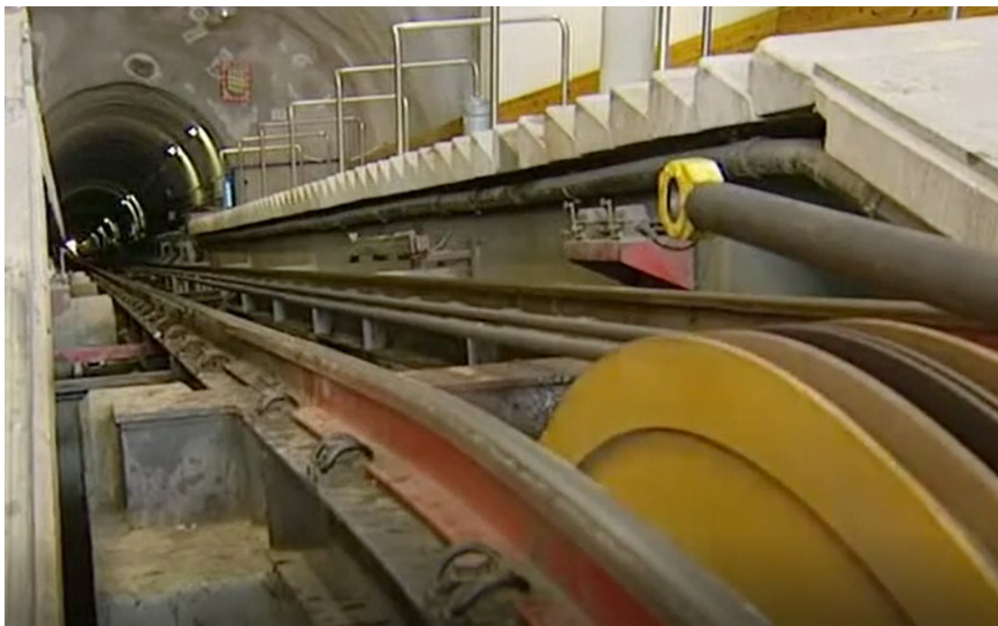
Сн 3. Макарата и въжето, задвижващи вагоните
