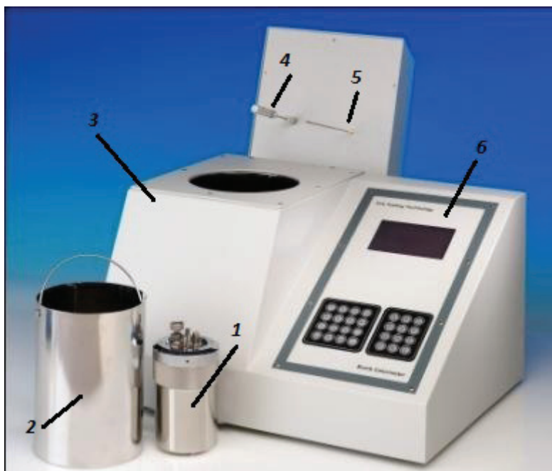
Фиг. 1. Калориметърът се състои от: 1– калориметрична бомба; 2 – калориметричен съд; 3 – адиабатна риза; 4 – бъркалка; 5 – уред за измерване на температурата; 6 – електронно устройство за отчитане на времето – таймер; термоелементи за регистриране на изменението на температурата и прибор за измерване на налягането в обема на бомбата.
