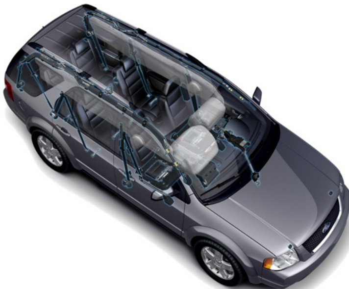
Фиг. 7 Въздушната възглавница за защита на водача, ако не е задействана обособява опасна зона с радиус около 40 см около волана.
