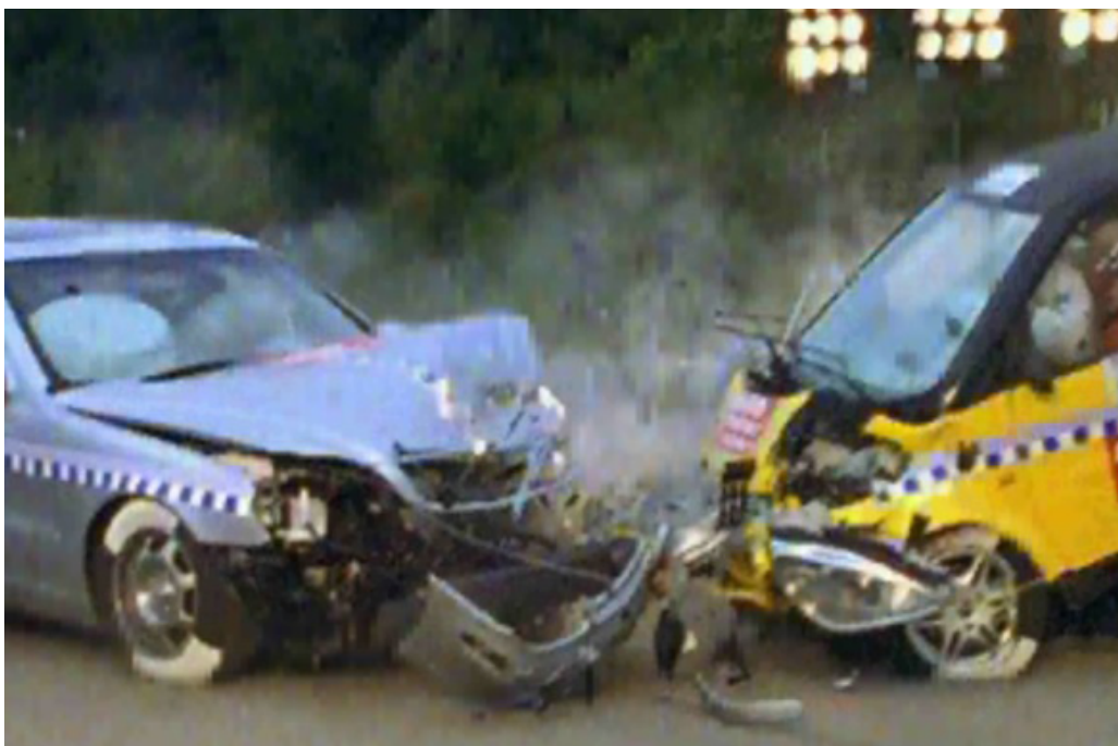
Фиг. 10 Двамата автомобила претърпяват тежки деформации в двигателната част, но салона с пътниците запазва своя обем, интервенция върху вратите на автомобила може да не се наложи.
