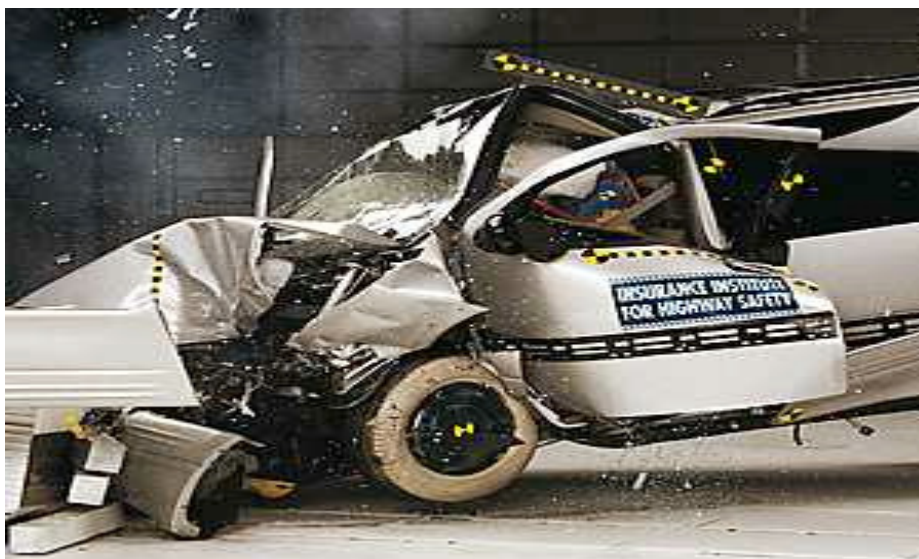
Фиг. 9 Незащитено купе на автомобил от края на миналия век, видими деформации на салона. Това е и един от критериите за необходимост от спасителни работи с помощта на хидравлични режещи инструменти.
