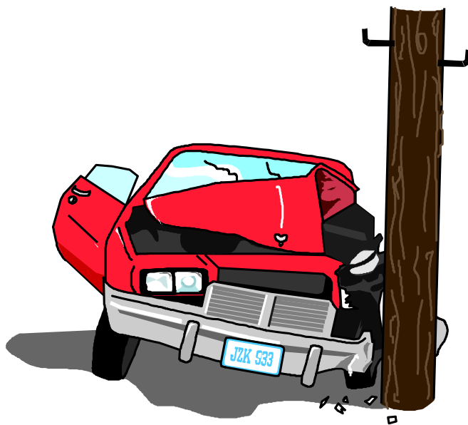
Фиг. 1 Удар в твърда преграда при 20 km/h – отговаря на падане на човек от височина 1,6 m.
