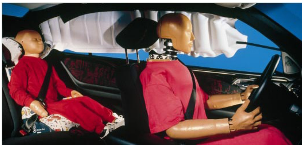
Фиг. 5 Странична завеса за защита на главите при страничен удар.
