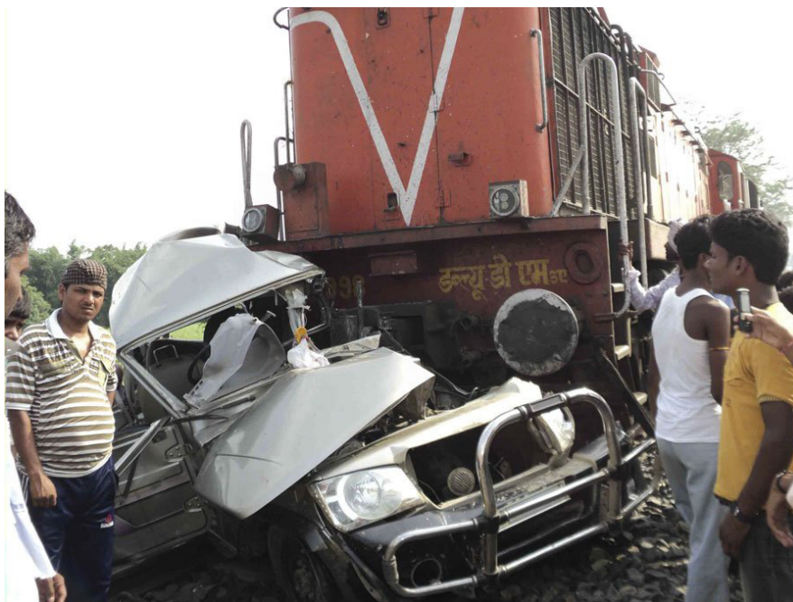
Фиг. 13 ПТП между железопътен състав и моторно превозно средство. Последниците от такъв удар са сериозни, поради невъзможността влакът да спре веднага. Возилото бива влачено, удряно в елементи от железопътния път и претърпява сериозни деформации.
