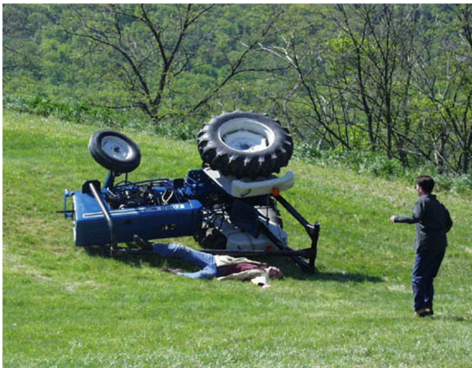
Фиг. 1 Кабината на машината се разпада и водачът остава затиснат от големия товар на основния агрегат – най-често това е двигателя.
