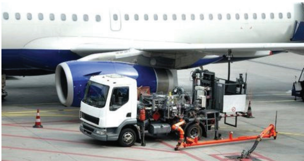
Фиг.3 Зареждането на самолета става от специален автомобил с високо налягане. На фигурата е представена помпена станция за зареждане на самолет с гориво от централен керосиновпровод под пистата.
