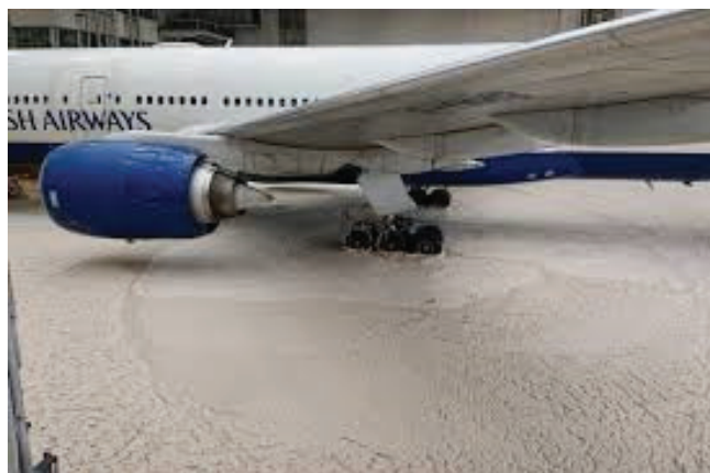
Фиг. 6 Направа на пени възглавници за спасяване на пътниците от летателното средство. Спасителните пързалки попаднали в разлетия горящ керосин се разтапят и бързо изгарят. Пътниците не могат да ги използват безопасно.
