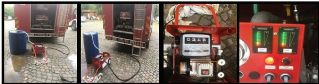
Фиг. 7. Зареждане с ПО на IVECO EUROCARGO.
