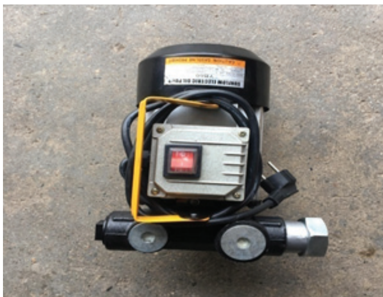
Фиг. 3. Общ вид на помпата и електродвигателя.
