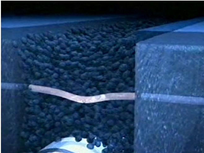
Сн. 11 Компютърна симулация на поддаването на газовата тръба, под натиска на почвата
